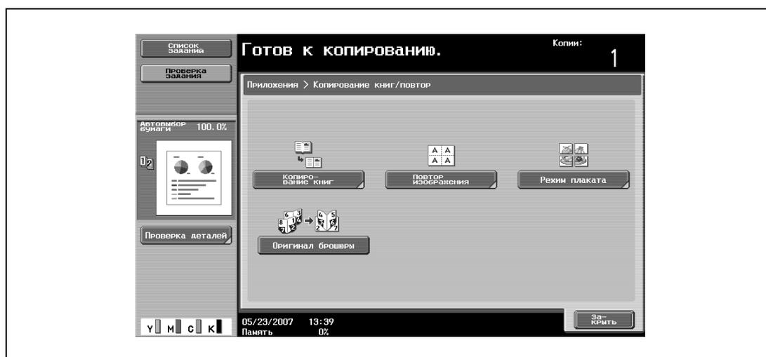
– [Оригинал брошюры] отсутствует, если не установлен дополнительный финишер. Появится экран "Копирование книг".
